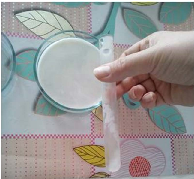
Рис. 2. Виявлений осад на склі пробірки під час оцінювання результатів проби відстоювання
